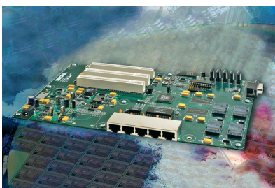
Рис. 2. Ethernet-платформа на базе KSZ8695P
