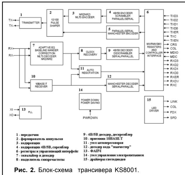
Рис. 2. Блок-схема трансивера KS8001.
