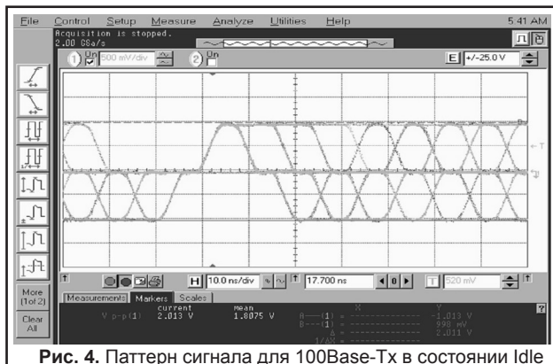
Рис. 4. Паттерн сигнала для 100Base-Tx в состоянии Idle
