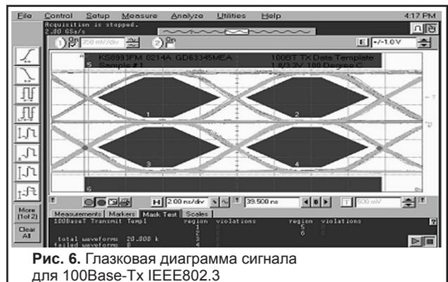
Рис. 6. Глазковая диаграмма сигнала для 100Base-Tx IEEE802.3
