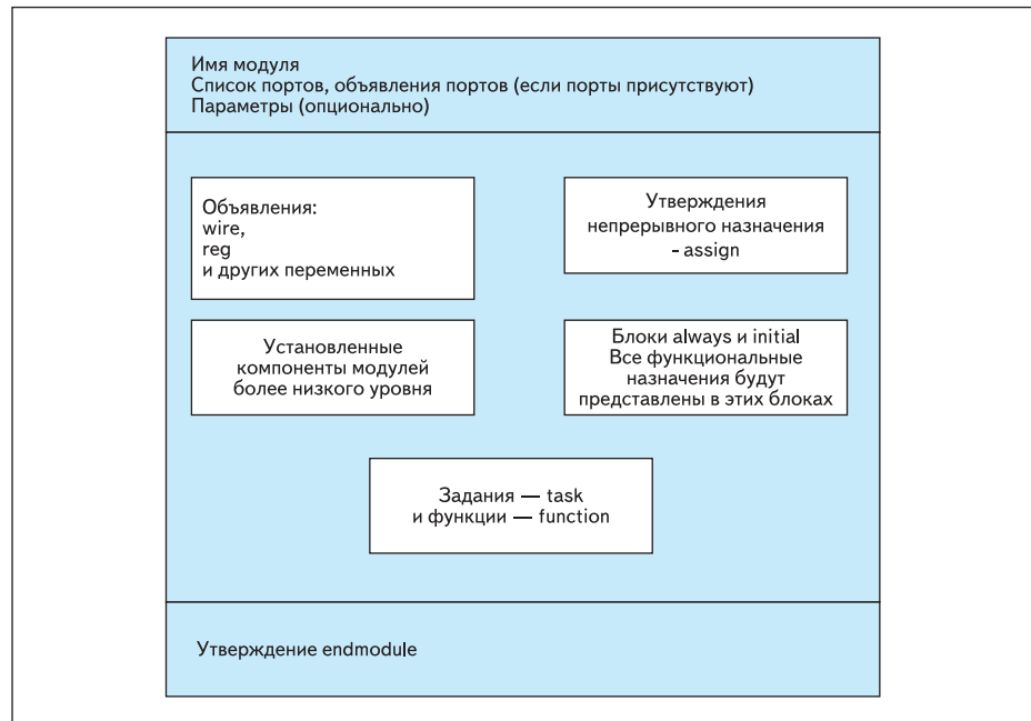
Рис. 4. Компоненты модуля в языке Verilog
