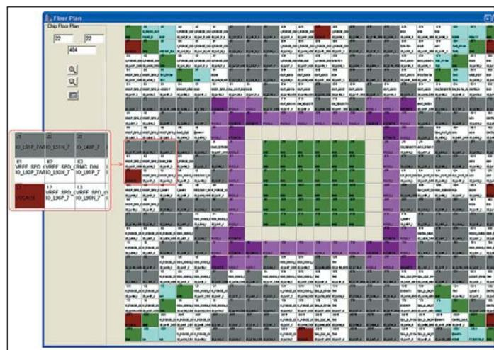
Рис. 4. Внешний вид окна программы с изображением выводов микросхемы в графическом виде
