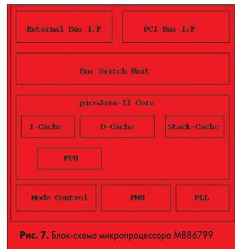
Рис. 7. Блок-схема микропроцессора MB86799
