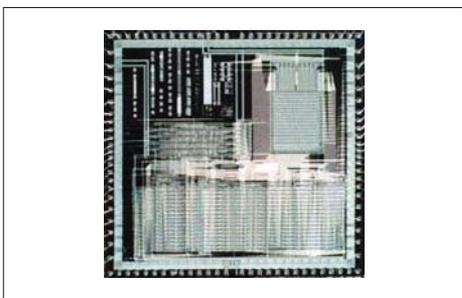
Во втором процессоре были добавлены внутренние стеки и урезаны шины для подключения внешних стеков. Кроме того, в него введена развитая система прерываний и аппаратный умножитель  $16 \times 16$ . В результате получился процессор, очень близкий по архитектуре с RTX 2000. Кристалл выполнен по КМОП-технологии 2,2 микрона и заключен в 100-выводной корпус PQFP.
