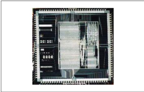
Советский вариант NC 4016. Разработчики повторили известный микропроцессор фирмы Novix, пользуясь при этом лишь спецификацией на архитектуру и систему команд. В результате получился совместимый кристалл, показавший хорошие параметры быстродействия для своего времени. Характерной особенностью Дофин-1610 стало использование дополнительной шины для подключения памяти стеков параметров и возвратов.
